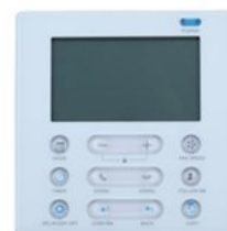
KJR-120C/BW-E (kompakt kazettás, légcsatornázható, parapet-mennyezeti készülékekhez)
